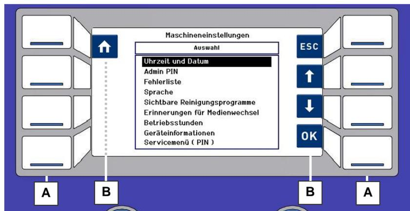
Abb. 3.10.1 Bedieneinheit mit Displayanzeige u. Navigationssymbolen
