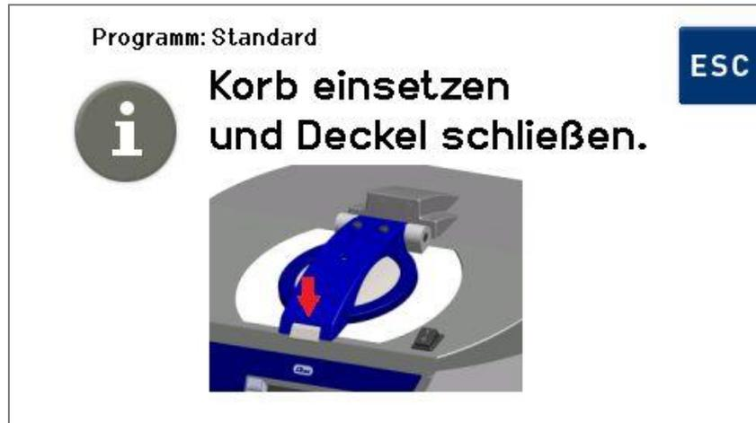
Abb. 6.3.2 Displayanzeige *Korb einsetzen – Deckel schließen*
