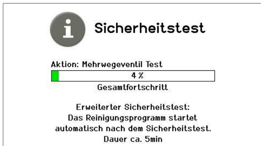
Abb. 10.4.3 Displayanzeige Fortschritt Sicherheitstest
