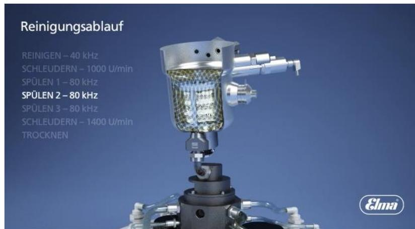
Abb. 3.1.2 Darstellung Reinigungskorb in Reinigungskammer
