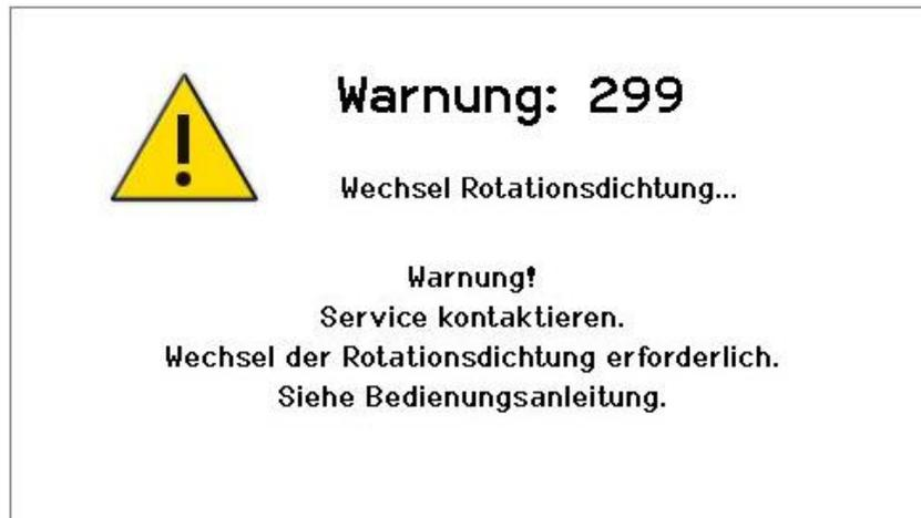
Abb. 10.3.1.2 Displayanzeige *Warnung: Korbrotationseinheit wechseln*
