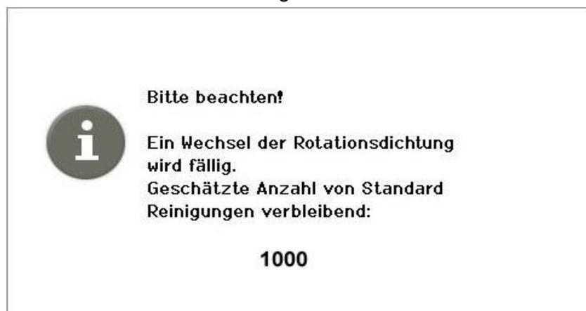
Abb. 10.3.1.1 Displayanzeige *Rotationsdichtung wechseln*
